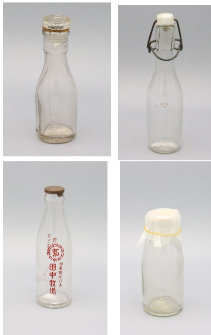
図6 ガラスびんの形状の変化 (左上) 内ネジ口 (右上) 機械口 (左下) 王冠口 (右下) 広口紙栓 (公財) 中田俊男記念財団 牛乳博物館収蔵
