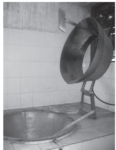
写真1 加糖練乳製造用平釜(2014年撮影)
