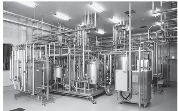
図11. 現行のUHT殺菌装置の外観（殺菌操作は全て自動）
