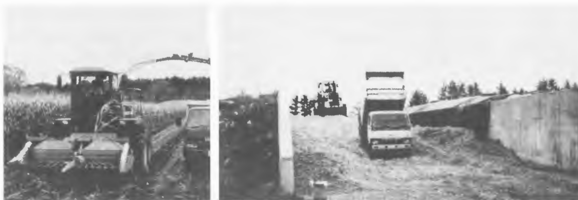
図28 自走ハーベスタでトウモロコシを収穫し、大規模バンカーサイロへつめこむ
