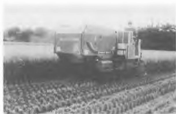
図27 自走式の飼料イネハーベスタ ロールベアラが組み込まれている
